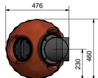
Der Abgangsstutzen für das Rauchrohr kann je nach Anschlusssituation gedreht werden.
